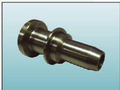
零件: 纺机零件 材料: 20Cr,调质 加工内容: 全加工 加工精度: 同心度0.01
