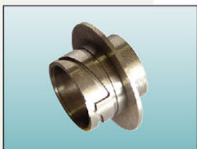
零件: 电联器 材料: 铝合金 加工内容: 全加工 加工精度: 同轴度0.02, 表面粗糙度Ra 0.8
