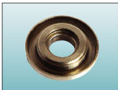
零件: 轴承内圈 材料: GCr15 加工内容: 硬车, 精加工 加工精度: 跳动0.005, 表面粗糙度Ra 0.4
